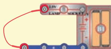
**3. Vodiče s kontaktmi:** Používajte tento miniobvod na testovanie jednotlivých vodičov s kontaktmi – každý jednotlivo. Žiarovka by mala svietiť.
